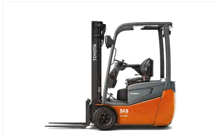
Kompakter 3-Rad-Stapler für einfaches Rangieren und Arbeiten in beengten Umgebungen.
