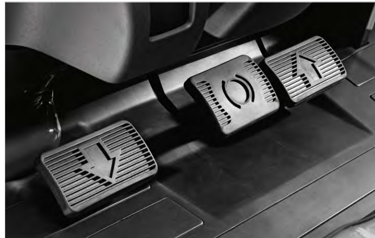
Es stehen unterschiedliche Pedalanordnungen zur Auswahl – bspw. als komfortable Doppelpedalanordnung.
