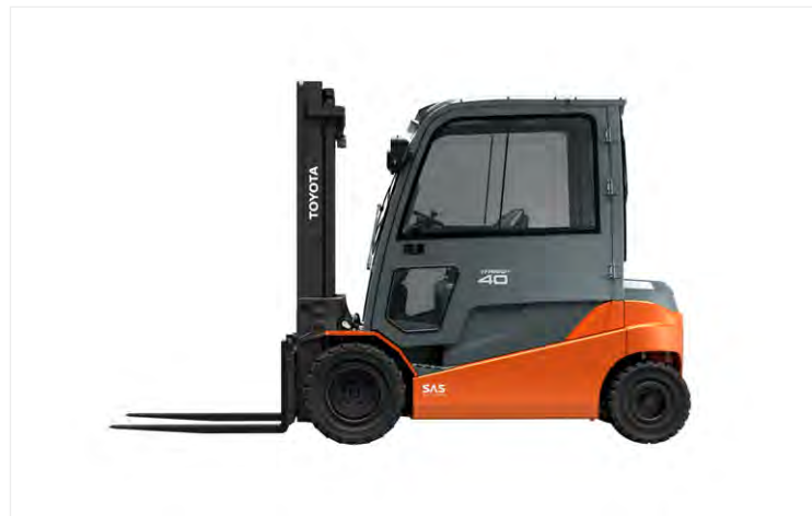
Kabinenoptionen bieten Wetterschutz, erhöhten Komfort und gute Rundumsicht.
