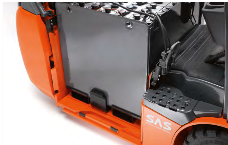
Seitliche Batterieentnahme: Einfahrtaschen (im Bild) oder integriertes Rollenbett.
