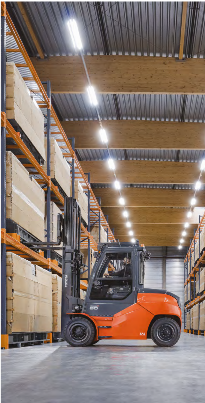
Geräumige, vollständig entkoppelte Fahrerkabine; geräusch- und vibrationsarm und deshalb besonders bequem.
