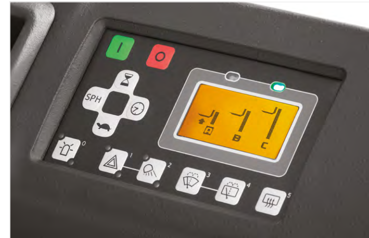
Die automatische Hubhöhenvorwahl erleichtert das Ein- und Auslagern und spart dem Fahrer Zeit.
