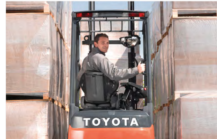
Der hintere Haltegriff verbessert den Komfort und die Produktivität beim Rückwärtsfahren, indem der Rücken des Fahrers entlastet wird. Der optionale Drehsitz erleichtert das Rückwärtsfahren sowie das Ein- und Aussteigen.
